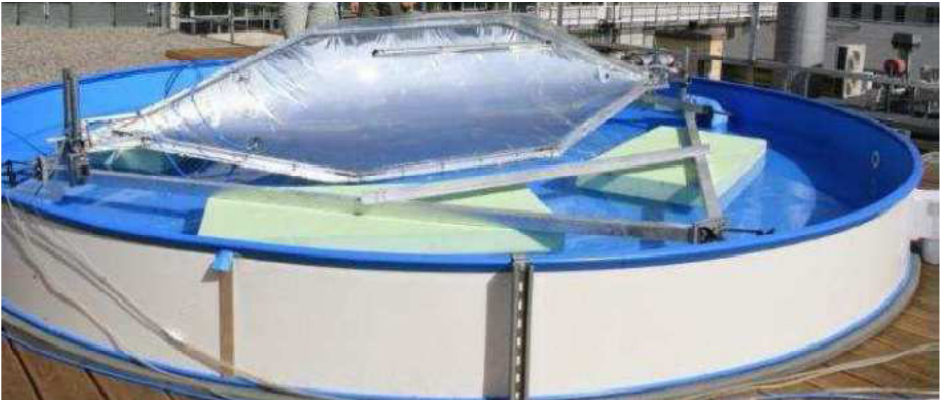
Bild 7: Schwimmend gelagerter, zweiachsig nachgeführter Konzentrator
