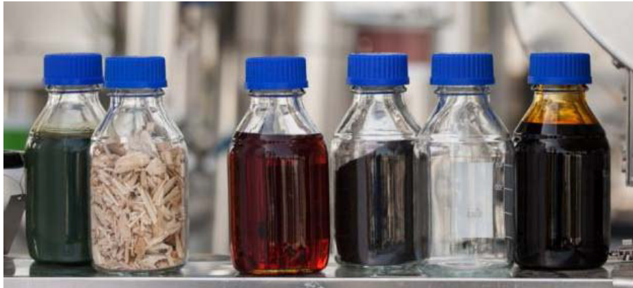
Abbildung 5: Rohstoffe und Produkte aus dem bioCRACK-Prozess (v.l.n.r: Trägeröl, Biomasse, Rohdiesel, Kohle, Gas und wässrige Phase = Pyrolyseöl)
