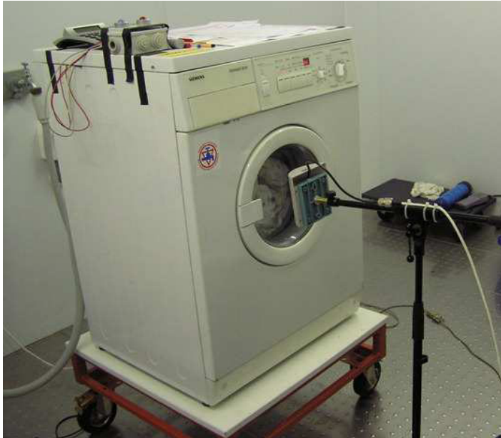
Bild 5: Ein Prüfwaschgang in der Klimakammer (auf Stativ die Funkerfassung der Temperaturwerte aus dem im Bottich befindlichen Temperatur-Datenlogger)
