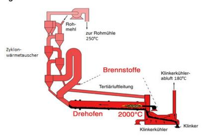
In der Zementproduktion muss heißer Klinker durch Einsatz von Luft schnell abgekühlt werden. Dadurch entstehen große Mengen an erwärmter Luft, die teilweise ungenützt in die Umgebung abgegeben wird. Die im Ofen erwärmte Luft wird in einem Zyklonwärmetauscher für die Vorerwärmung der Rohmaterialien genutzt und gelangt dann zur Rohmühle.
