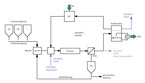
Nach Austritt aus der Trocknungstrommel wird das getrocknete Material zum **Hauptfilter** gefördert. Dort wird es aus dem Gas ausgeschieden. Die Filteranlage enthält eine senkrechte Prallplatte durch welche der Gasstrom um 180° umgelenkt wird. Bei dieser Umlenkung wird der größte Teil des Feststoffs aus dem Kreislauf abgeschieden und gelangt in einen Auffangbehälter.
