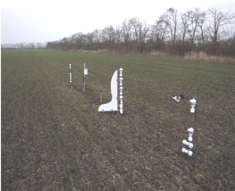
**Abbildung 10** Feststehende (ganz links und rechts) und drehbarer Sedimentsammler (Mitte) sowie Bodenfeuchtheitsmessung (links)
