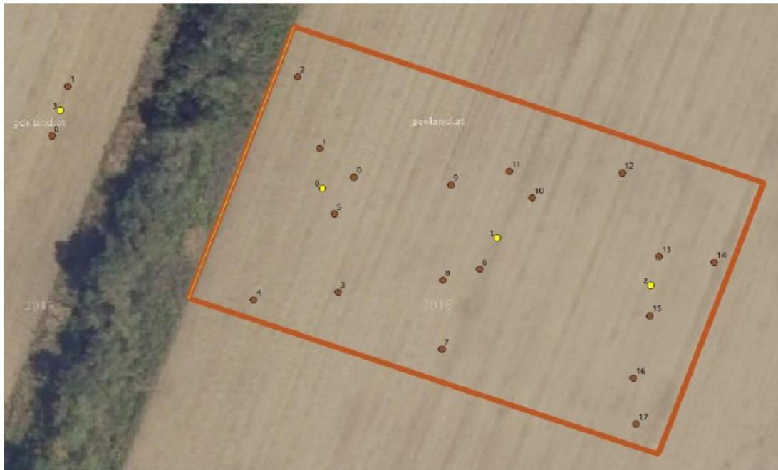
**Abbildung 8** Versuchsaufbau am Standort Rutzendorf. Die gelben Punkte zeigen drehbare, die roten feststehende Sedimentsammler an. Die Punkte sind mit der Sammlernummer versehen. Die Referenzmessungen fanden luvseitig von der Hecke statt.
