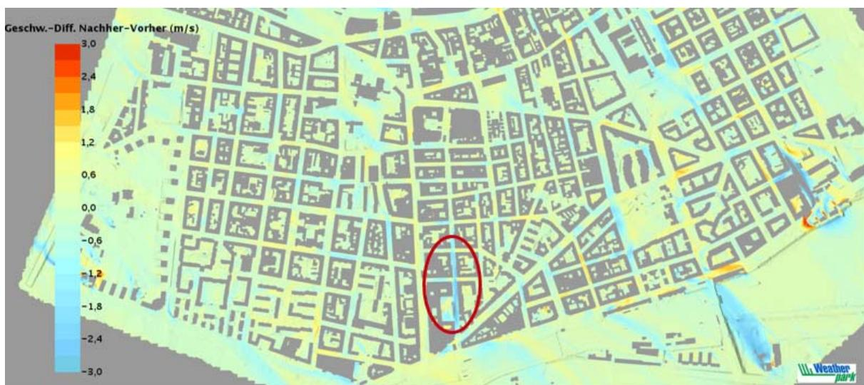
Abbildung 8: Änderungen der Windgeschwindigkeit in großem Maßstab durch hypothetische Verdichtung im zentralen Meidling (SO-Wind)
