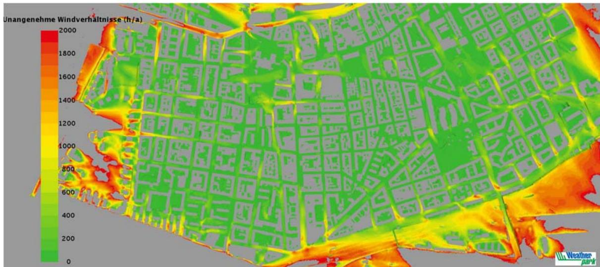
Abbildung 7: Verteilung der unangenehmen Windgeschwindigkeiten (Wind aus SO-Richtung) im gesamten zentralen Meidling (SO-Wind)
