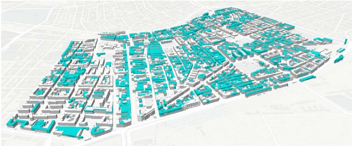
Abb. 2: 3D Modell einer hypothetischen großräumigen Verdichtung basierend auf den Vorgaben der maximalen Bauhöhe im Bebauungsplan im dicht verbauten Teil von Meidling (mögliche Gebäudeerhöhungen dargestellt in blau).
