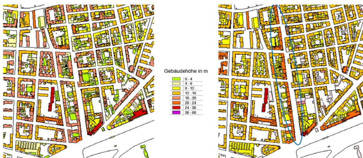
Abbildung 4: Gebäudehöhenverteilung heute (linkes Bild) und nach hypothetischer Verdichtung (rechtes Bild) des zentralen Meidling aufgrund der lokalen Gebäudehöhenschwellen - ausgeschnitten. (Quelle: AIT).
