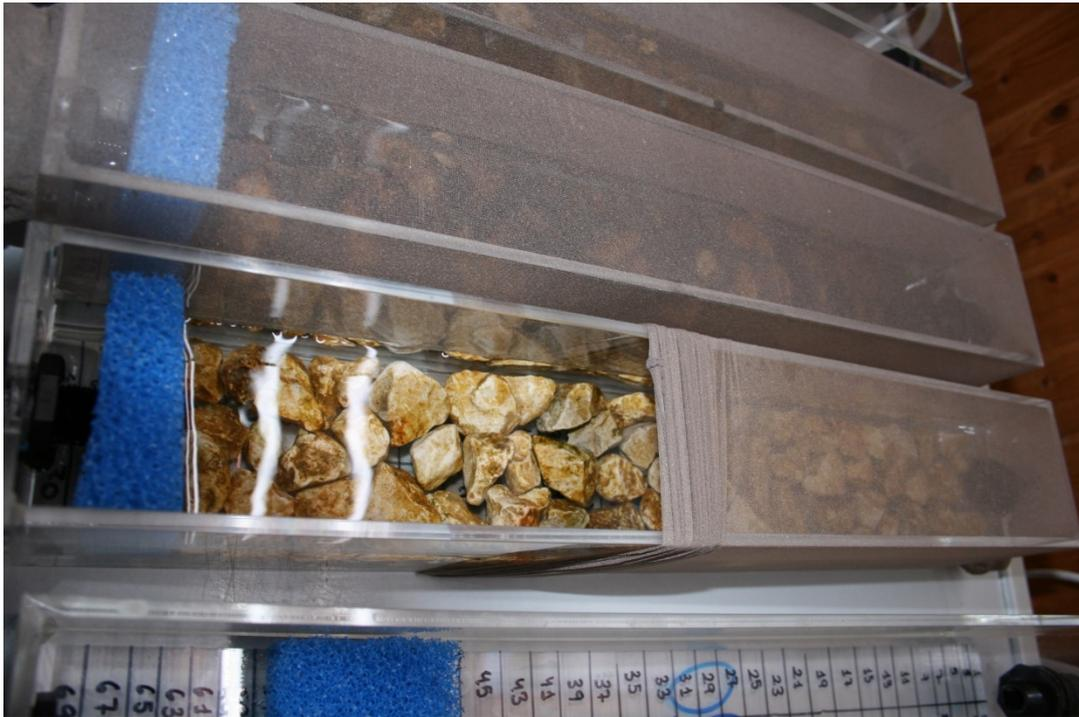
Die Feinsedimente wurden in 0,5 m lange Plexiglasrohre (4 cm Durchmesser) gefüllt, die mit einer peristaltischen Pumpe für einen langsamen stetigen Durchfluss sorgten. Die Rohre waren verdunkelt.
