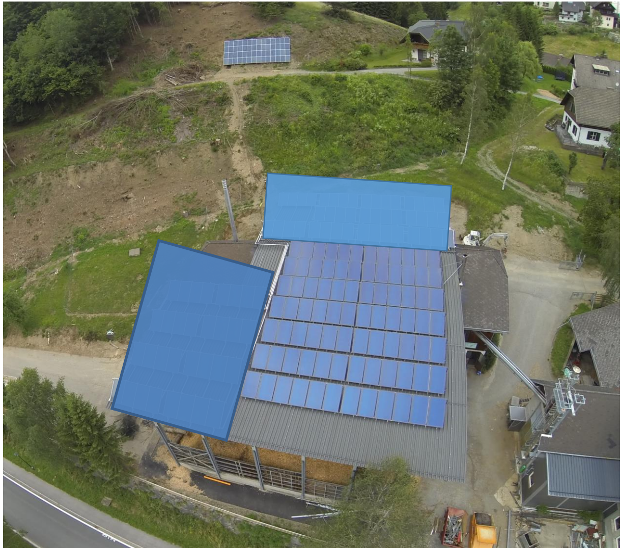
geplante Erweiterung der Solarthermie Heizwerk Fritzer
