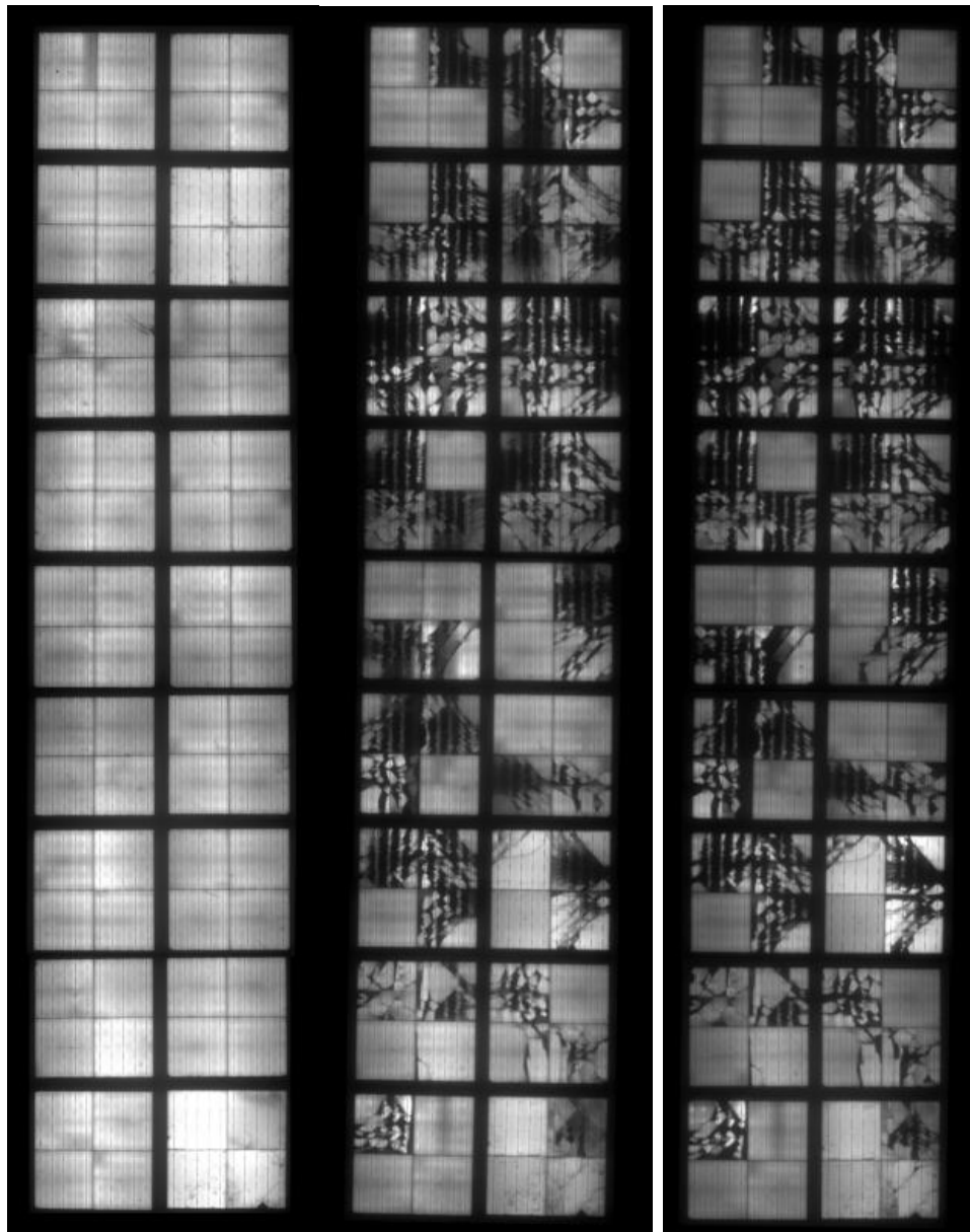
Abbildung 116: EL-Aufnahmen von String 2.37 im Mai 2022 (oben), Mai 2023 (Mitte) und Oktober 2023 (unten) (eigene Darstellung)
