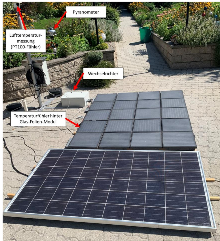
Abbildung 21: Messaufbau für die Erstellung des stationären Ein-Parameter-Temperaturmodells (eigene Darstellung)
