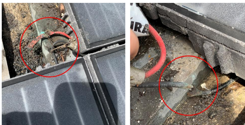
Abbildung 53: Lokalisierte Kabelunterbrechungen im String 2.42 (links) und Strang 2.41 (rechts) mit der Signalübertragungsmethode (eigene Darstellung)
