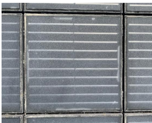
Abbildung 35: Delamination an den Modulrändern (09.08.2022) (eigene Darstellung)
