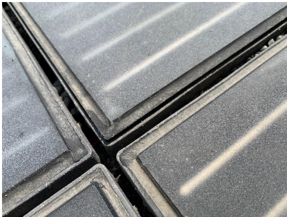
Abbildung 31: Ablösung des Moduls am Rand (22.07.2022) (eigene Darstellung)
