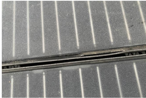
Abbildung 44: beginnender ausbrechender Modulrand (30.10.2023) (eigene Darstellung)
