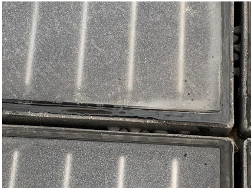
Abbildung 43: austretendes Wasser bei Belastung (30.10.2023) (eigene Darstellung)
