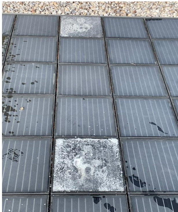
Abbildung 40: Module mit Glasbruch (festgestellt durch Mitarbeiter*innen der Gemeinde Teesdorf) (07.02.2023) (eigene Darstellung)
