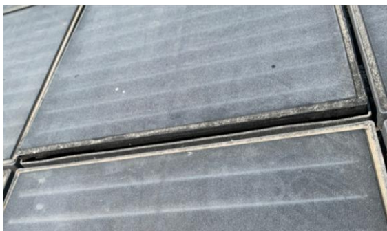
Abbildung 33: Ablösung des Moduls über die gesamte Randfläche (22.07.2022) (eigene Darstellung)
