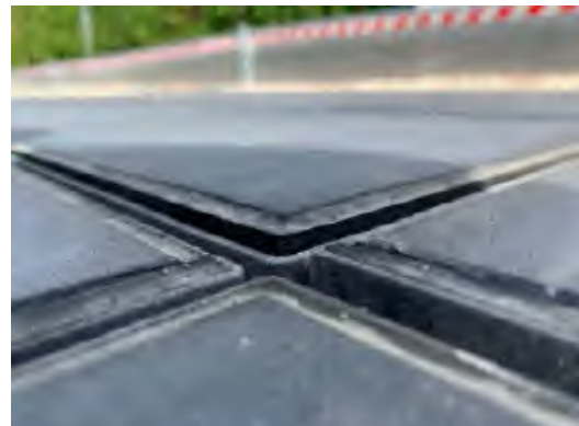
Abbildung 36: Ablösung des Moduls an der Modulecke (09.08.2022) (eigene Darstellung)
