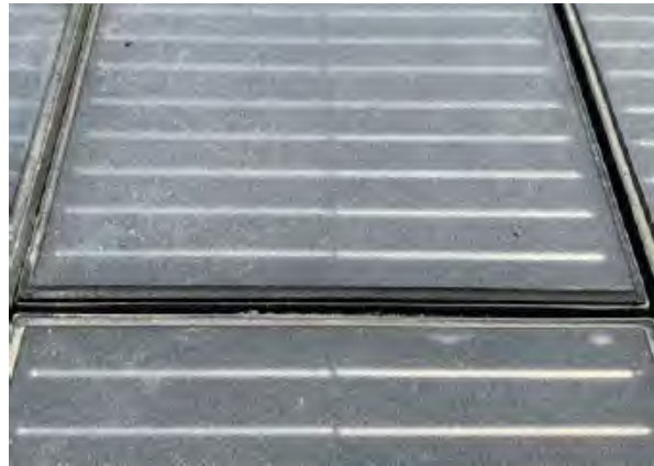
Abbildung 32: Ablösung des Moduls über die gesamte Randfläche (22.07.2022) (eigene Darstellung)
