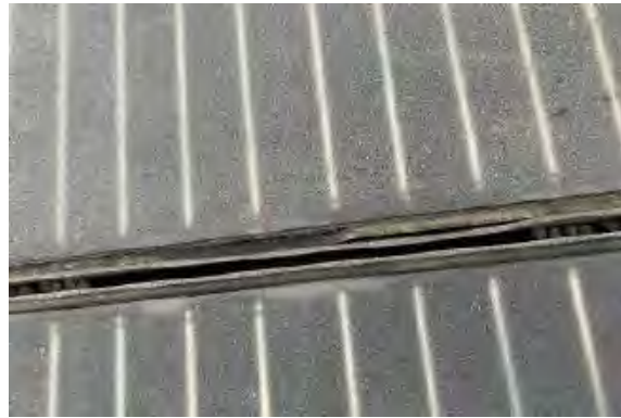
Abbildung 44: beginnender ausbrechender Modulrand (30.10.2023) (eigene Darstellung)
