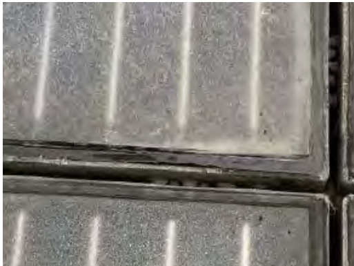
Abbildung 43: austretendes Wasser bei Belastung (30.10.2023) (eigene Darstellung)
