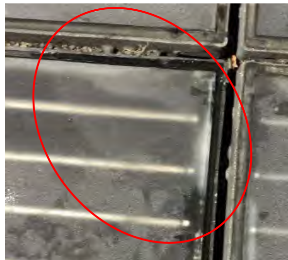
Abbildung 42: Delamination an der Modulecke zwischen Glas und Einkapselungsfolie (02.10.2023) (eigene Darstellung)
