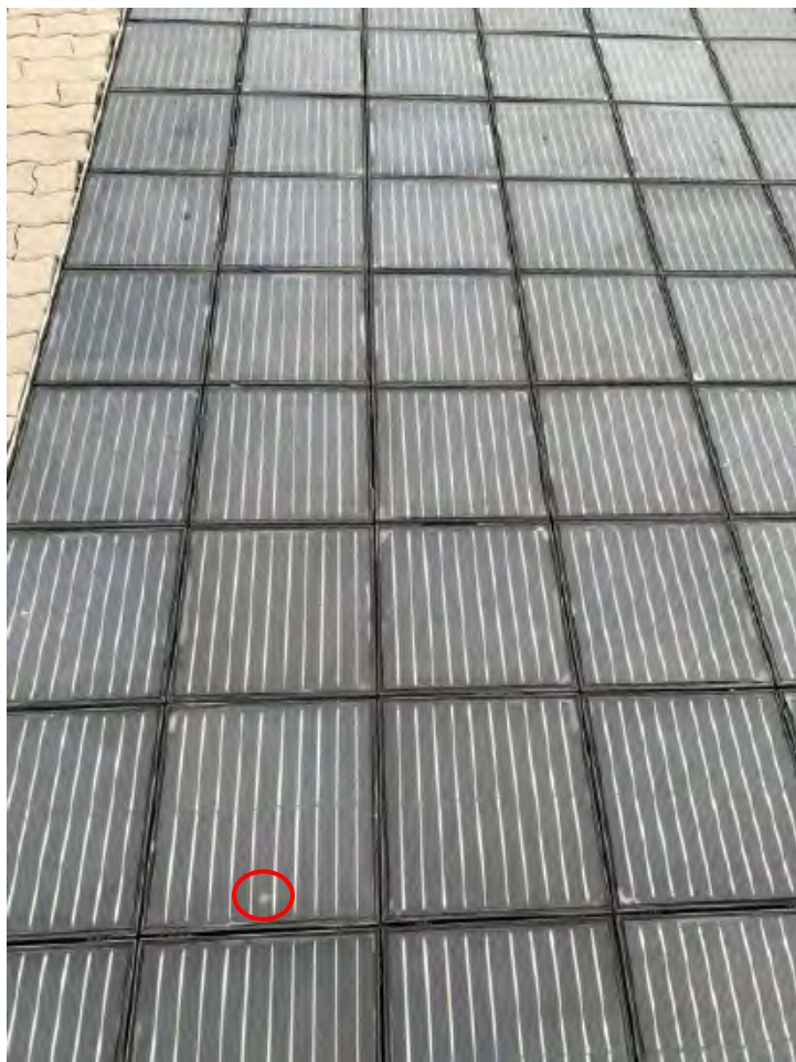
Abbildung 45: Delaminationen an den Modulrändern sowie in der Modulmitte (siehe Markierung) (30.10.2023) (eigene Darstellung)
