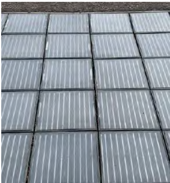
Abbildung 38: Delaminationen an den Modulrändern (07.02.2023) (eigene Darstellung)
