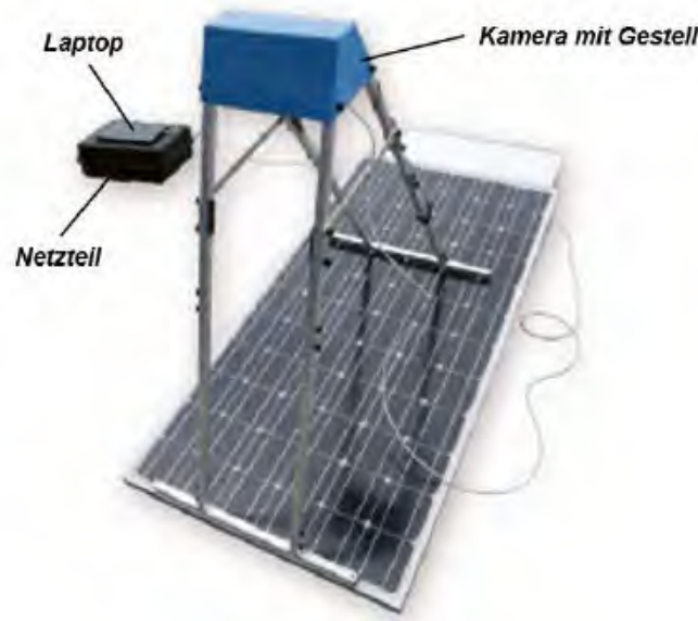
Abbildung 22: Aufbau der „MBJ Mobilen EL“ von MBJ (adaptiert aus (MBJ Solutions GmbH 2021))
