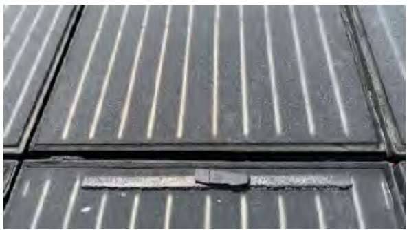
Abbildung 34: Ablösung des Moduls und ausbrechender Rand (22.07.2022) (eigene Darstellung)
