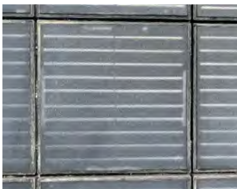
Abbildung 35: Delamination an den Modulrändern (09.08.2022) (eigene Darstellung)
