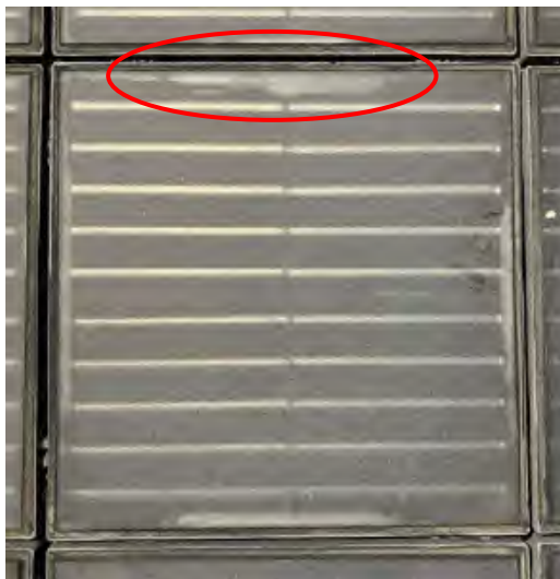
Abbildung 41: Delaminationen an den Modulrändern bis über die PV-Zellen (02.10.2023) (eigene Darstellung)
