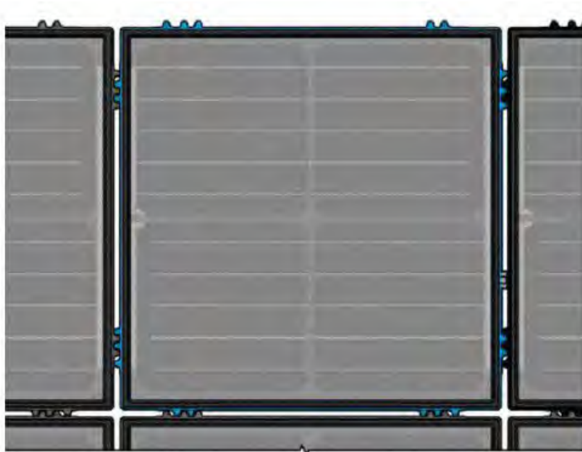
Abbildung 3: Verzahnung der PV-Module ineinander (Innovatív Térburkolatfejlesztő 2021)
