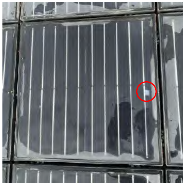
Abbildung 39: Delaminationen an den Modulrändern und neben einer Busbar (07.02.2023) (eigene Darstellung)
