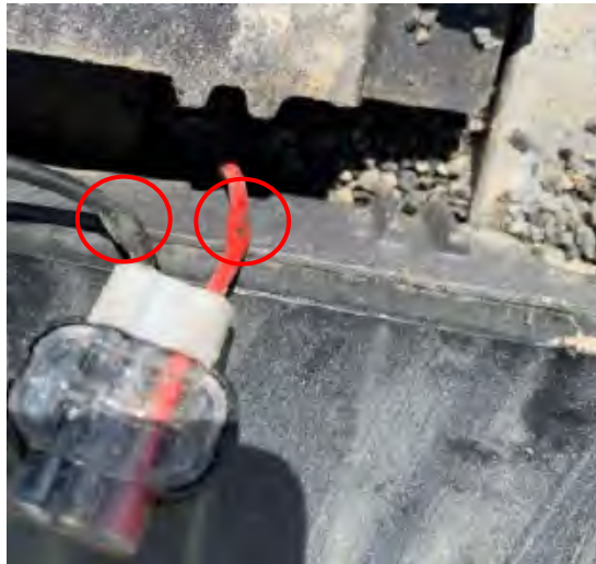
Abbildung 37: gequetschte Stringkabel (09.08.2022) (eigene Darstellung)
