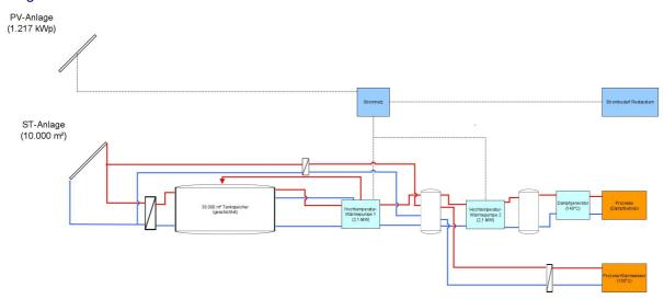
Abbildung 8: Prinzipschema der Variante 1 inklusive Dimensionierung
