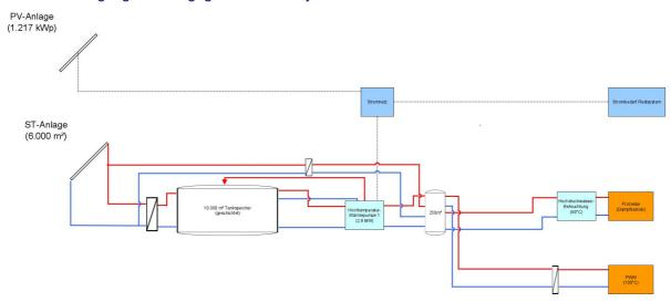
Abbildung 17: Prinzipschema der Variante 2 inklusive Dimensionierung
