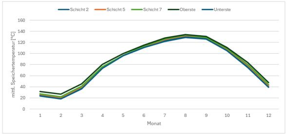
Abbildung 32: Temperaturverlauf der monatlichen Mittelwerte im Langzeit-Wärmespeicher für Variante 4
