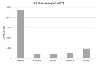
Abbildung 39: Variantenvergleich hinsichtlich der CO2-Emissionen
