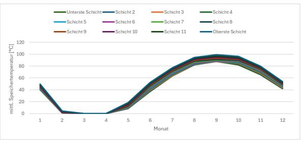
Abbildung 19: Temperaturverlauf der monatlichen Mittelwerte im Langzeit-Wärmespeicher für Variante 2
