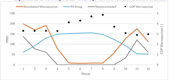
Abbildung 11: gesamter Strombedarf Wärmepumpenkaskade, Netzstrombedarf unter Berücksichtigung der lokalen Erzeugung und COP der Wärmepumpe für Variante 1
