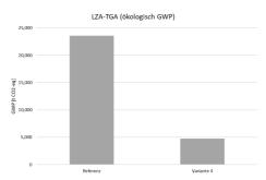
Abbildung 29:  $CO_2$ -Emissionen über den Betrachtungszeitraum von 20 Jahren für Variante 3 im Vergleich zum Referenzsystem
