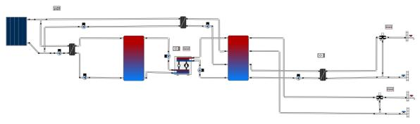
Abbildung 5: Abbildung der Variante 2 mit Hochtemperaturkollektoren in Polysun und Zieltemperatur Dampf 60°C (Quelle: Polysun)
