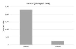
Abbildung 23:  $CO_2$ -Emissionen über den Betrachtungszeitraum von 20 Jahren für Variante 2 im Vergleich zum Referenzsystem
