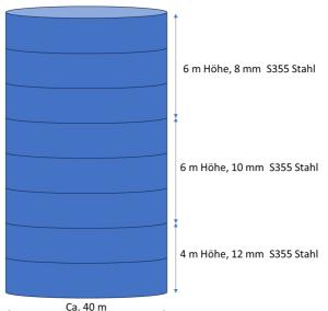
Abbildung 7: Grobentwurf eines 20.000m³ Tankspeichers
