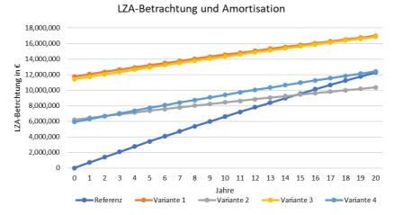
Abbildung 38: Variantenvergleich hinsichtlich LZA-Betrachtung und Amortisation (inkl. Förderung)
