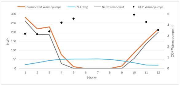
Abbildung 33: gesamter Strombedarf Wärmepumpenkaskade, Netzstrombedarf unter Berücksichtigung der lokalen Erzeugung und COP der Wärmepumpe für Variante 4
