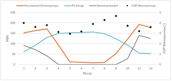
Abbildung 20: gesamter Strombedarf Wärmepumpenkaskade, Netzstrombedarf unter Berücksichtigung der lokalen Erzeugung und COP der Wärmepumpe für Variante 2
