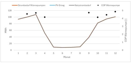
Abbildung 26: Netzstrombedarf Wärmepumpenkaskade und COP der Wärmepumpe für Variante 3
