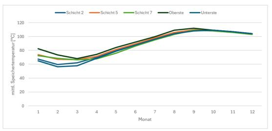
Abbildung 10: Temperaturverlauf der monatlichen Mittelwerte im Langzeit-Wärmespeicher für Variante 1
