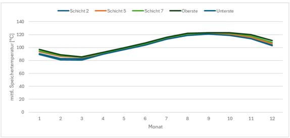
Abbildung 25: Temperaturverlauf der monatlichen Mittelwerte im Langzeit-Wärmespeicher für Variante 3
