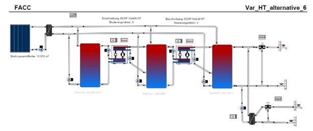
Abbildung 4: Abbildung der Variante 1 mit Hochtemperaturkollektoren in Polysun und Zieltemperatur Dampf  $140\,^{\circ}\text{C}$  (Quelle: Polysun)
