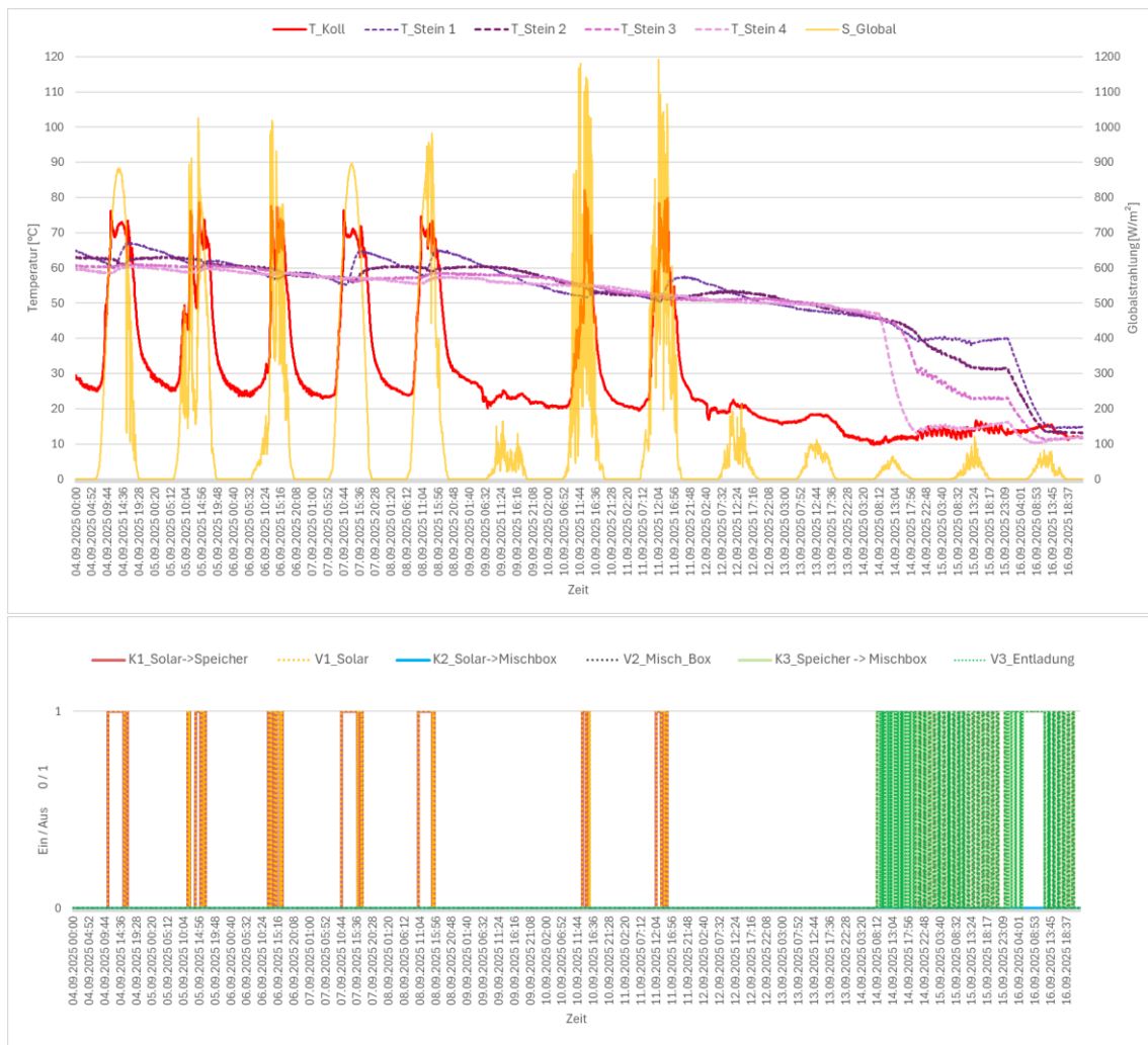
Abbildung 47 Beispielhafter Verlauf von Temperaturen, solare Einstrahlung, Kollektortemperatur und Steinspeichertemperaturen sowie Erzeugermodi (4.9. – 16.9.2024)
