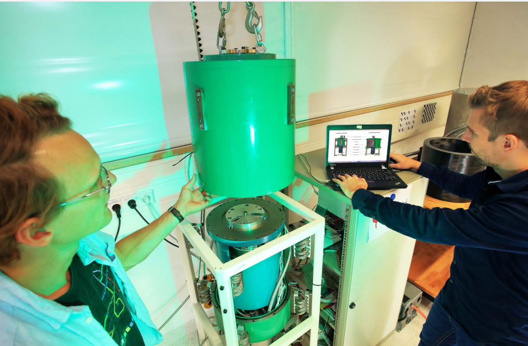
FlyGrid Schwungradspeicher mit 100 kW Leistung im Test bei der Energy Aware Systems Measurement Arbeitsgruppe der TU Graz
