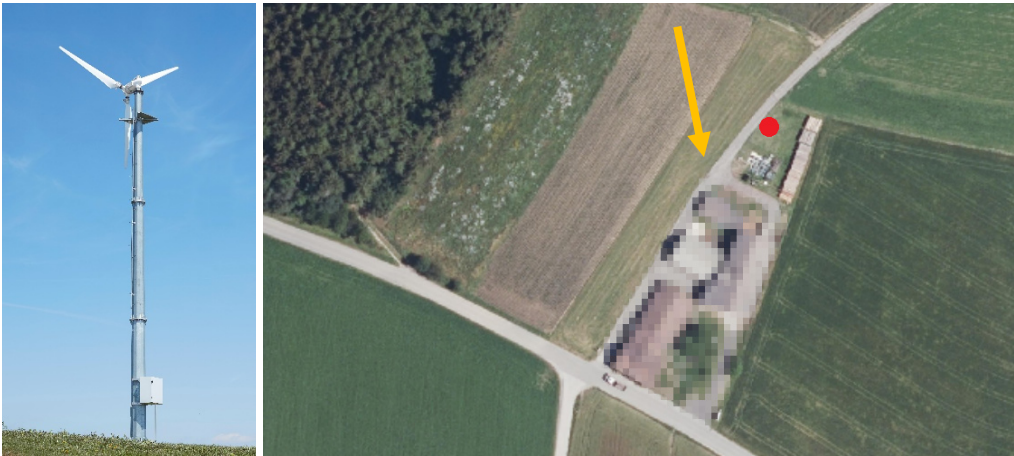
Abbildung 21: 10-kW Kleinwindkraftanlage (links) und ausgewählter Standort (roter Punkt) sowie Hauptwindrichtung (rechts)
