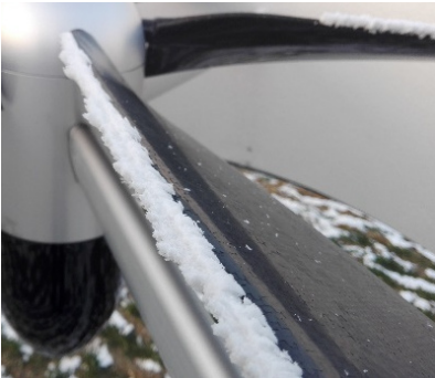
Abbildung 4: Vereisungsereignis Kleinwindkraft Hügelland (Standort Lichtenegg NÖ) – Anlagenleistung 1 kW
