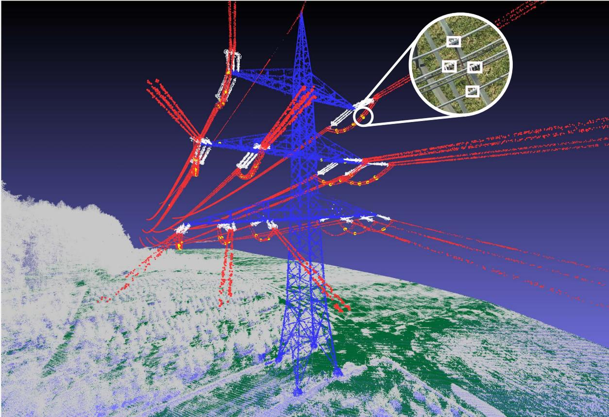
„Mit VOLTAIR konnten wir die automatisierte Inspektion von Stromnetzen ein gutes Stück voranbringen. Mit der automatischen Befundung von Störstellen in UV und IR sind wir dem Stand der Technik voraus, auch Schutzrechte unsererseits sind in Anmeldung. Im Projektkonsortium haben wir uns gut ergänzt: das Domänenwissen der TU Graz und unser Know-how in der automatischen Bildanalyse.“ PROJEKTLLEITER JOSEF ALOIS BIRCHBAUER
