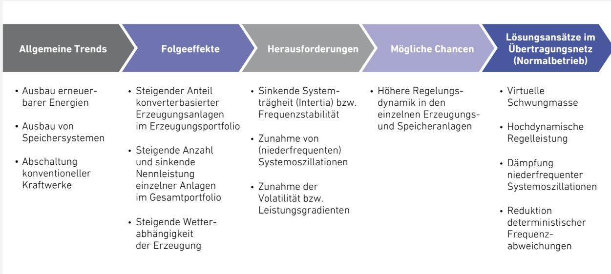
Systemcharakteristika und relevante Größen im Verteiler-/Übertragungsnetzbetrieb
