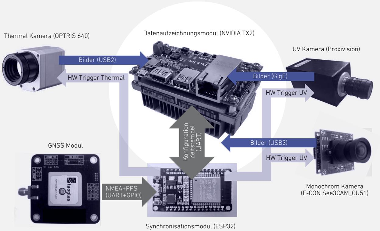
Sämtliche für die Datenerfassung erforderlichen Komponenten und Funktionalität wurden im Sensorkopf integriert. Die einzige verbleibende Schnittstelle zum Fluggerät ist die Stromversorgung. Zentrale Komponente ist das Prozessormodul, das die Datenaufnahme der Kameras steuert und die aufgenommenen Bilddaten mit exakten Zeitstempeln aus dem GNNS Modul verspeichert (Abbildung 2).
