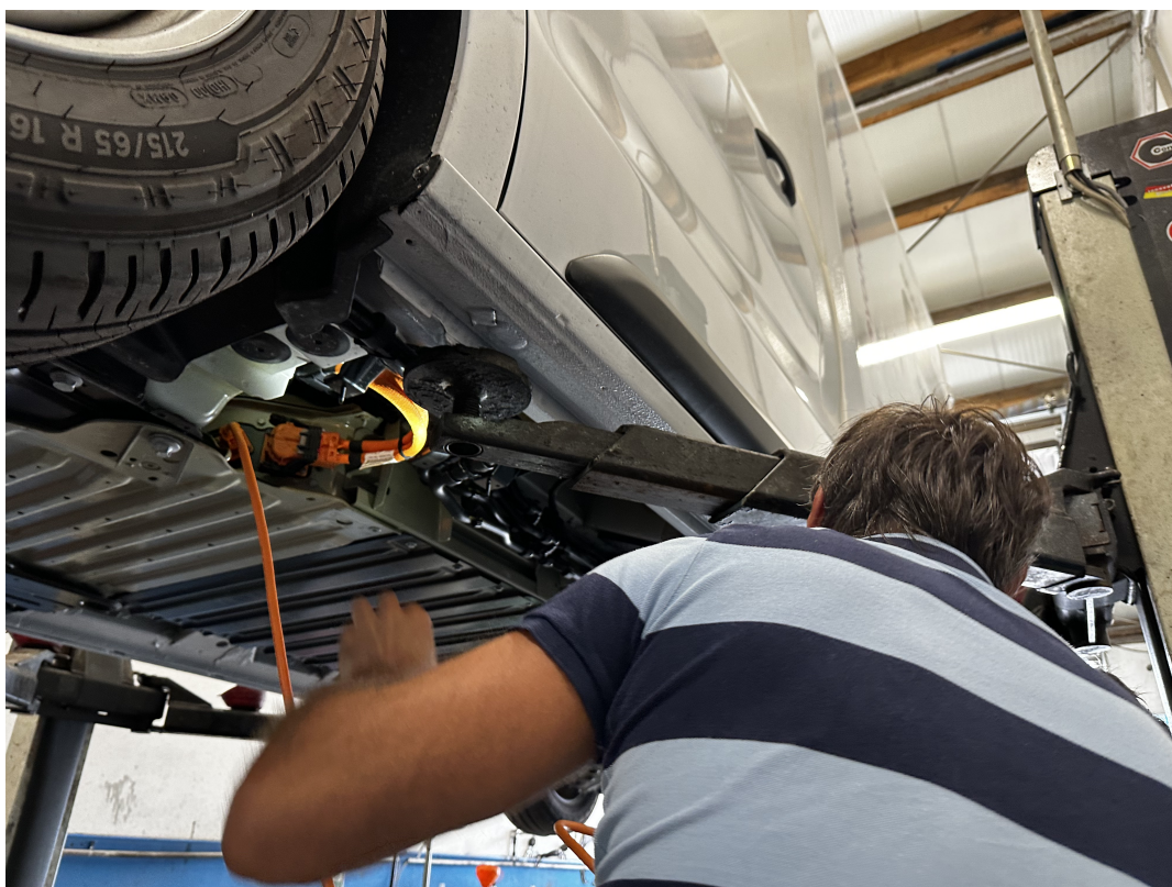
Abbildung 3: Anschluss an den ePTO des Fahrzeugs und Test des bidirektionalen V2P-Systems.
