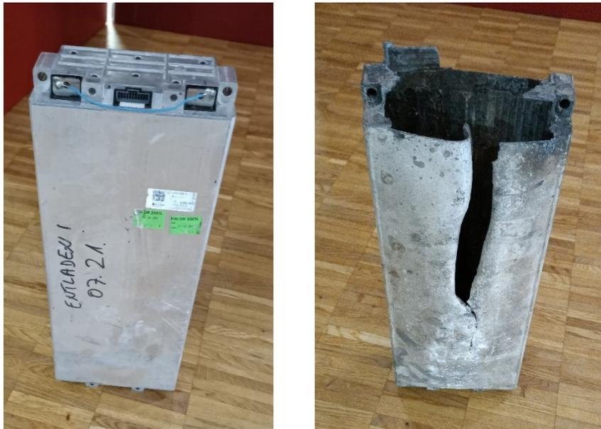
Abbildung 6: Batteriemodul (linkes Bild) und ausreagiertes Batteriemodul nach einem thermal runaway (rechtes Bild)
