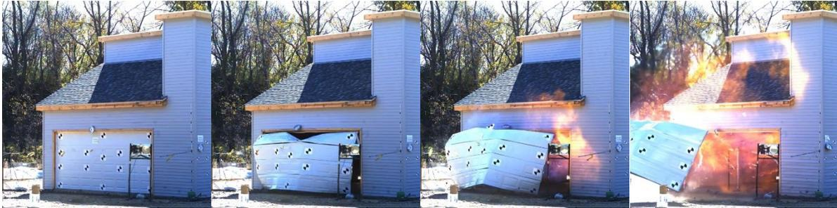
Abbildung 8: Versuch des Fire Safety Research Institutes (FSRI) zur Explosion von Venting-Gasen in Garagen (laufende Untersuchung)
