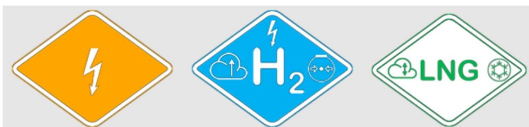
Abbildung 9: Kennzeichnungssymbole nach ISO 17840-4 für Elektrofahrzeuge (linkes Symbol), Wasserstofffahrzeuge (mittleres Symbol) und LNG-Fahrzeuge (rechtes Symbol)
