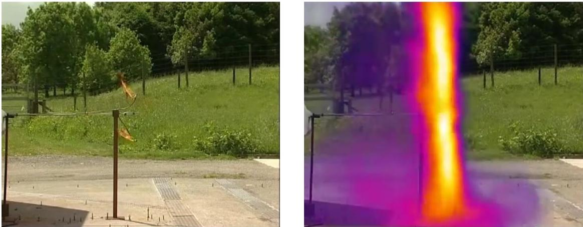
Abbildung 15: Bild einer Wasserstoffflamme (links vor Freisetzung des Wasserstoffs), überlappendes Wärmebild aufgenommen mit einer Wärmebildkamera nach Freisetzung (rechtes Bild) (Quelle: HyResponder)
