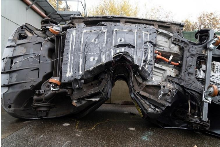
Abbildung 17: Ergebnis des DEKRA -Crashtests mit starker Deformation des Fahrzeuges und der Traktionsbatterie
