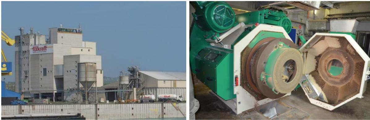
Abbildung 184: Ansicht des Betriebsgebäudes (links) sowie des Futtermittelextruders (rechts) der Anlage "Fixkraft Kraftfutter", Bildquelle: Fixkraft-Futtermittel GmbH
