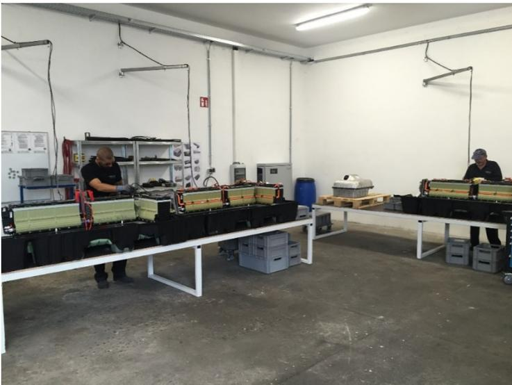
Abbildung 10: Entlade- und Demontagestation der Fa. Redux GmbH (Arnberger et al. 2018)
