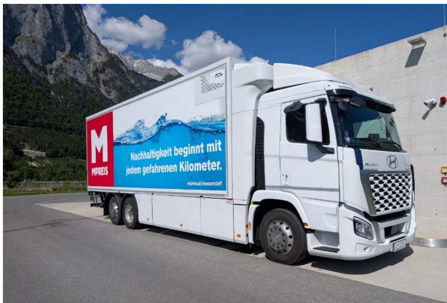
Abbildung 3: Hyundai Xcient 6x2 mit Kühlkofferaufbau von EMPL.
