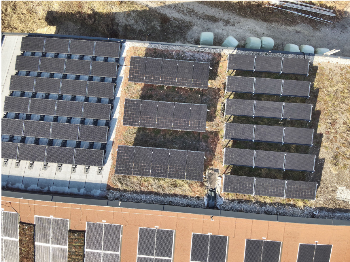
Abbildung 11: Vegetation in den Versuchsflächen GD-PV_b, GD-PV_a und GD (von links nach rechts) am 31.12.2024, ganz links: PV ohne Begrünung (Drohnenfoto: Gerold Steinbauer)
