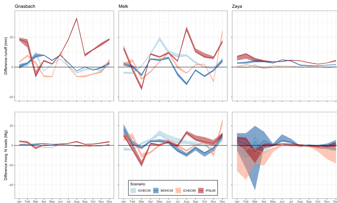
Abb 7. Veränderungen des simulierten Oberflächenabflusses (obere Tafeln) und der anorganischen N-Fracht ( \text{NO}_3^- -N und \text{NH}_4^+ -N) (untere Tafeln) für jedes der Klimaszenarien im Vergleich zum Referenzzeitraum (1981-2010).
