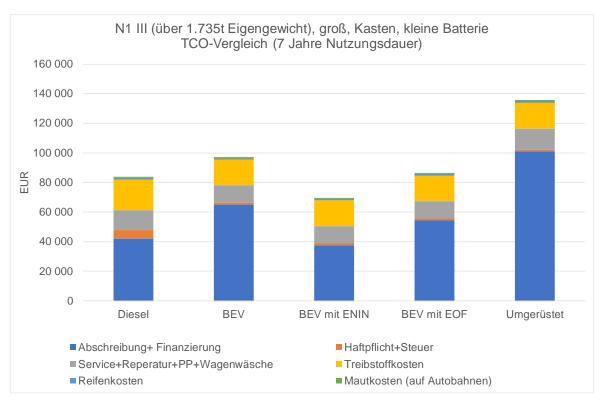
Abbildung 6: TCO-Vergleich für Fahrzeuge N1 / Gruppe III (großer Kastenwagen, kleine Batterie)
