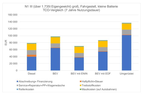
Abbildung 8: TCO-Vergleich für Fahrzeuge N1 / Gruppe III (Fahrgestell, kleine Batterie)
