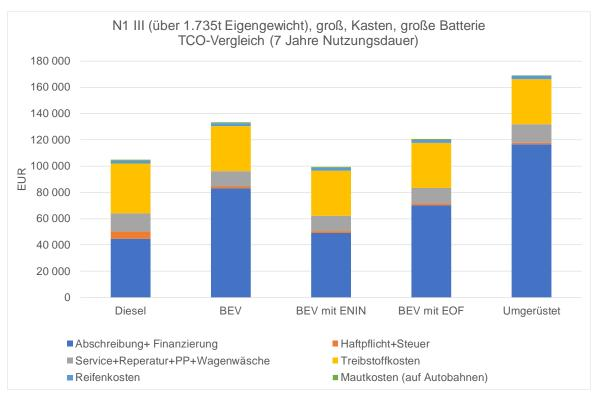
Abbildung 7: TCO-Vergleich für Fahrzeuge N1 / Gruppe III (großer Kastenwagen mit großer Batterie)
