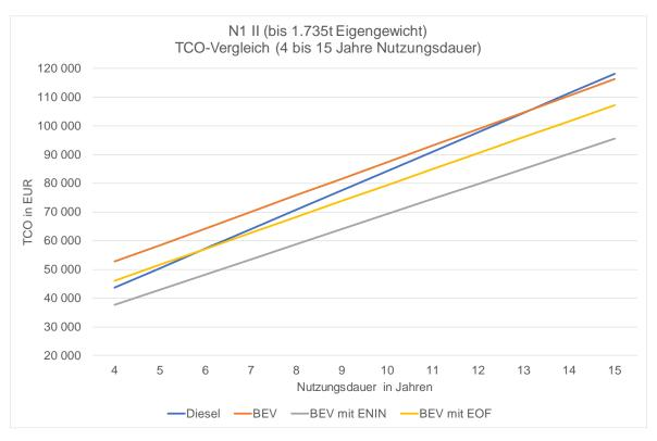
Abbildung 10: TCO-Vergleich für N1/II in Abhängigkeit der Nutzungsdauer
