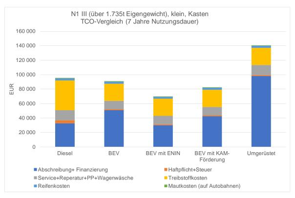
Abbildung 5: TCO-Vergleich für Fahrzeuge N1 / Gruppe III (kleiner Kastenwagen)
