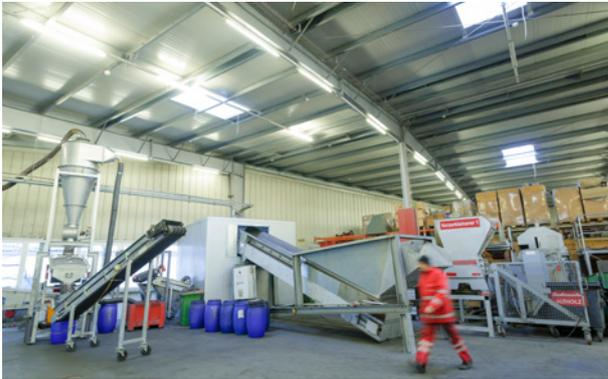
RE<sup>2</sup>BA-Versuchsanlage für Batterierecycling bei der Fa. Saubermacher,
